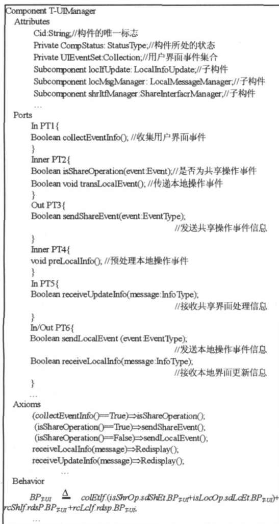
图5 共享界面处理构件、本地消息处理构件和本地信息更新构件的复合规约描述
